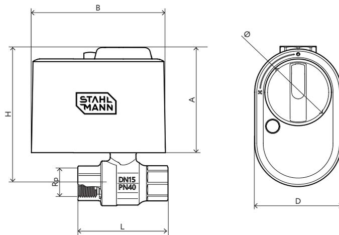
Рис. 3. Установочные размеры
