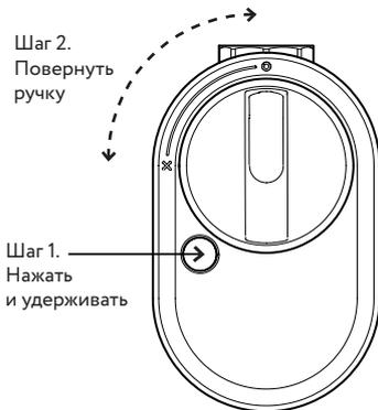
Рис. 4. Ручное управление краном шаровым с электроприводом
