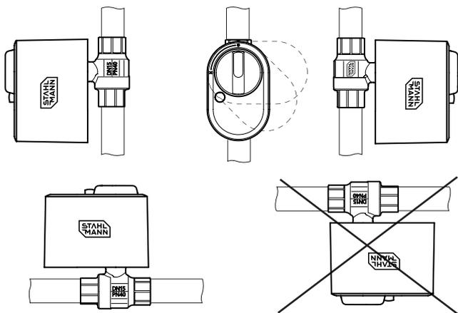
Рис. 1. Варианты установки крана шарового с электроприводом.
